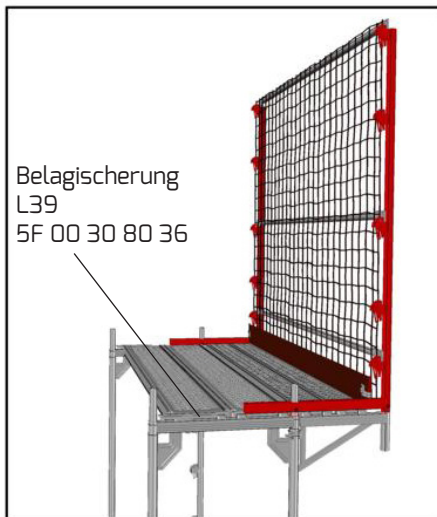
Dachdeckerfangschutz (nicht Bestandteil der Zulassung) Schutzgitterstütze in Verbindung mit Vertikalrahmen und Konsole B50
