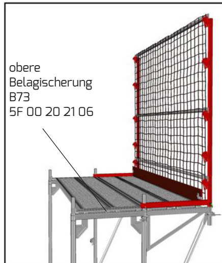
Dachdeckerfangschutz Schutzgitterstütze in Verbindung mit Vertikalrahmen, Konsole B73 und Querdiagonale
